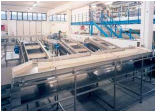
Macchine facenti parte di una linea per pelare il pomodoro.
