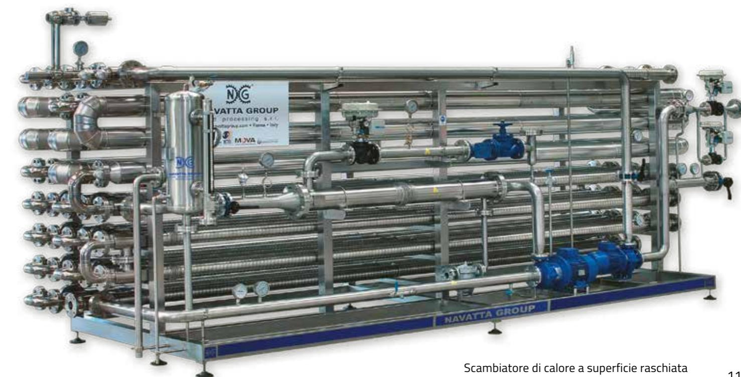
Scambiatore di calore a superficie raschiata
