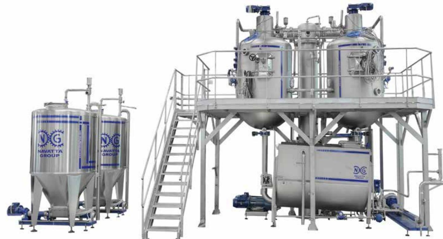
Bolle di cottura ed evaporazione con agitatore verticale con possibilità di lavorare sottovuoto o a pressione atmosferica
